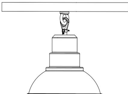
*Obs.: Verifique se a estrutura do local de instalação suporta o peso da luminária. Utilizar peso adicional pode reduzir a estabilidade mecânica.*
