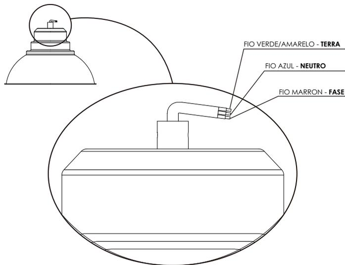
*Obs.: Desligar a rede elétrica para realizar a instalação.*
