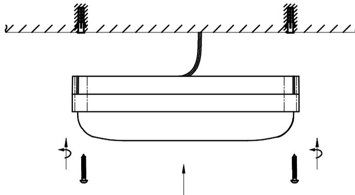
Faça a fixação do Blindado LED utilizando os parafusos.
