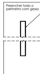
Nota\*: Para facilitar a limpeza, cobrir com fita adesiva a superfície do LLS antes de aplicar o gesso, remova a fita após a instalação e faça a limpeza com pano úmido para remover os resíduos.
